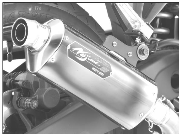
※スプリングを掛ける際、ラジオペンチ等を使用するとスプリングに傷が入り、スプリングが折れる原因になります。スプリングフックを使用して作業する事をお勧めします
