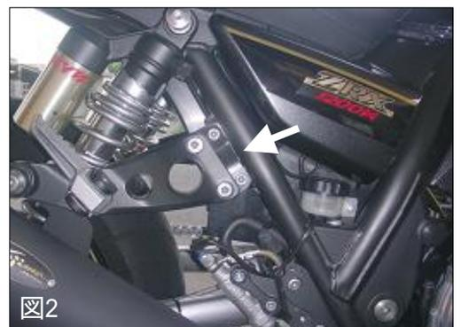
ラジオペンチ等で挟んでのスプリング掛け作業はスプリング折損の原因になります。必ず正しい工具をご使用下さい。
