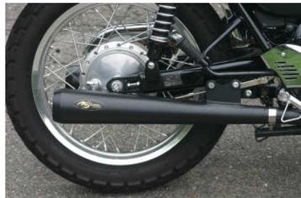
細身のメガホンサイレンサーは、内部構造を一から見直す事で厳しい騒音規制をクリアしながらも、あの頃をほうふつとさせる心地よい音質を再現。横から見た時のフレームとのバランスにこだわったエキパイは、その一部を二重管とする事でWシリーズのマフラーで最も気になる熱によるエキパイの焼けを最小限に抑えました(注1)。性能面にももちろん抜かりは無く、超フラットトルクなノーマルの特性にノジマならではの突き抜ける様なピーク域の伸びをプラス。見て、乗って楽しいマフラーに仕上がりました。
