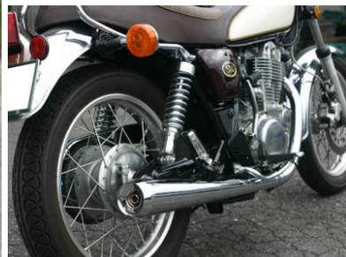
細身のメガホンサイレンサーは、美しく磨き上げたステンレスを丁寧にクロームメッキ処理する事で、ステンレスマフラー独特の汚い焼けを最小限に抑え、その美しさを永く保ちます(注1)。又、音的には、内部構造を一から見直し、音とパワーのバランスを最適化。シングルらしい心地よい音質を再現し、美しいそのスタイルにふさわしく、大人が乗って恥ずかしくない音になりました。性能面では、特によく使う常用域でのトルク感とピーク付近の伸びを重視。手軽なスリップオンながら、音・性能・見た目すべてにおいてSRビギナーからベテランまで納得させる1本に仕上がっています。もちろん安心のJMCA認定マフラーです。
