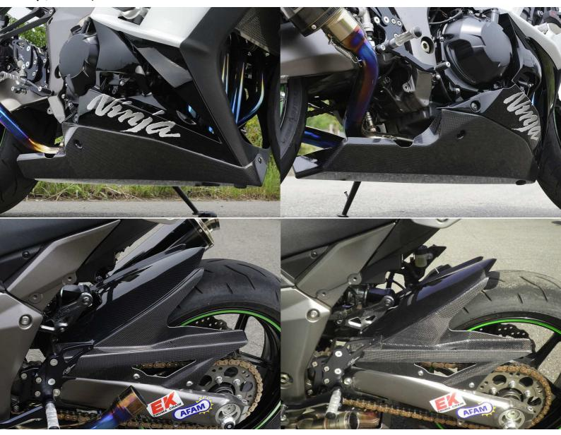
純正カウルに被せるタイプのアンダーカウルは比較的低コストでフルカバー化を実現、シャープなリアフェンダーはドレスアップはもちろん、純正比約70mmロング仕様で泥除け効果UP。フェンダーレス時の必需品です。
